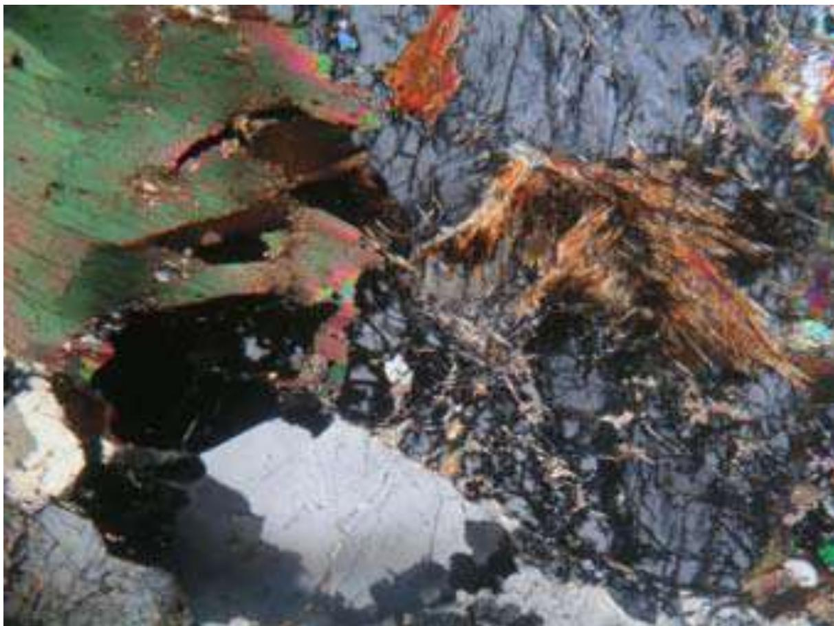
Document 3 : Micrographie de l'échantillon 3 en LPNA (en haut) et LPA (en bas) – Fd : feldspath, Bio : Biotite, Micro : microcline, Qz : Quartz
